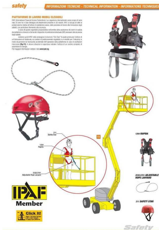
Esempio di corretto impiego di DPI contestualmente all'uso di PLE.
